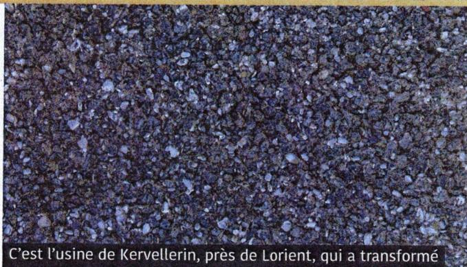
C'est l'usine de Kervellerin, près de Lorient, qui a transformé les coquilles d'huîtres en broyat pour le béton coquillé.
